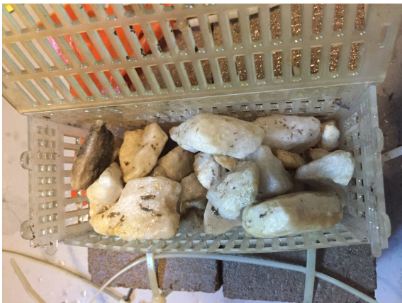
FIGURE 2.2 – Trappes avec sédiments fins sur le gravier
