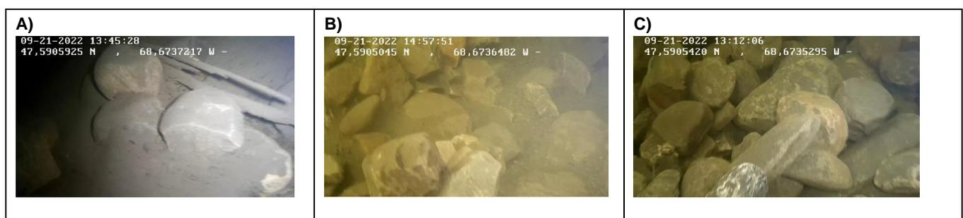
**Figure 3-2 : Exemples de photos montrant A) des roches éparses, B) du substrat manquant et C) une épaisseur de substrat suffisante.**
