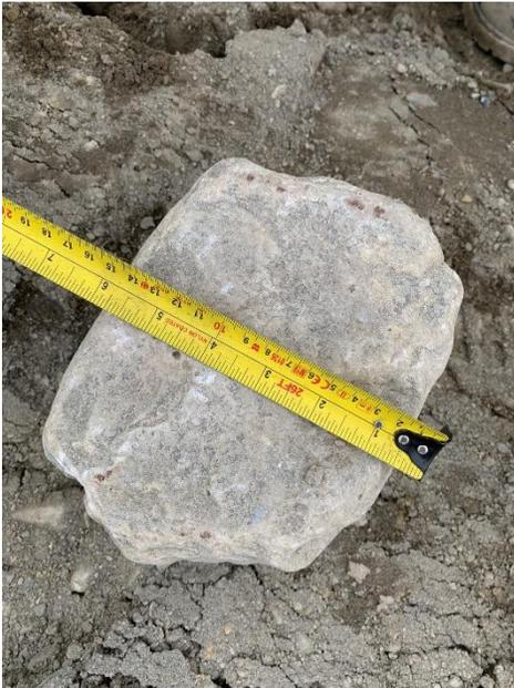
**Photo 3-1 : Pierre d'une grosseur d'environ 150 mm utilisée lors des travaux d'aménagement de frayère**
